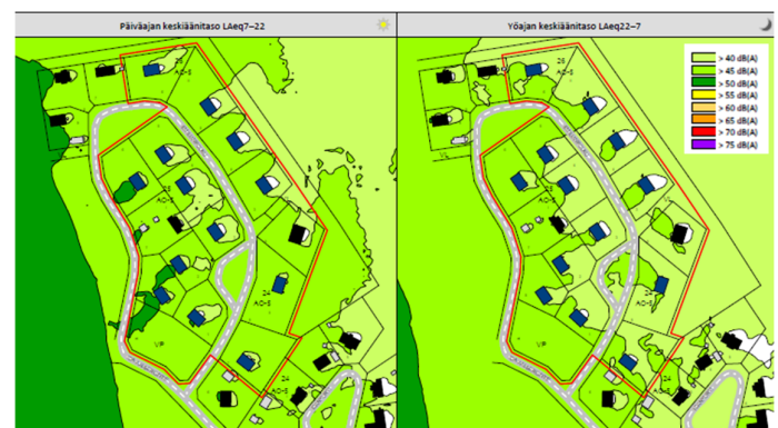
Kuva 24. Ulkoaluiden päivä- ja yöajan keskiäänitasot suunnitellulla maankäytöllä (havainnollistavat uudisrakennukset), GPS-nopeuksilla laskettuna.
