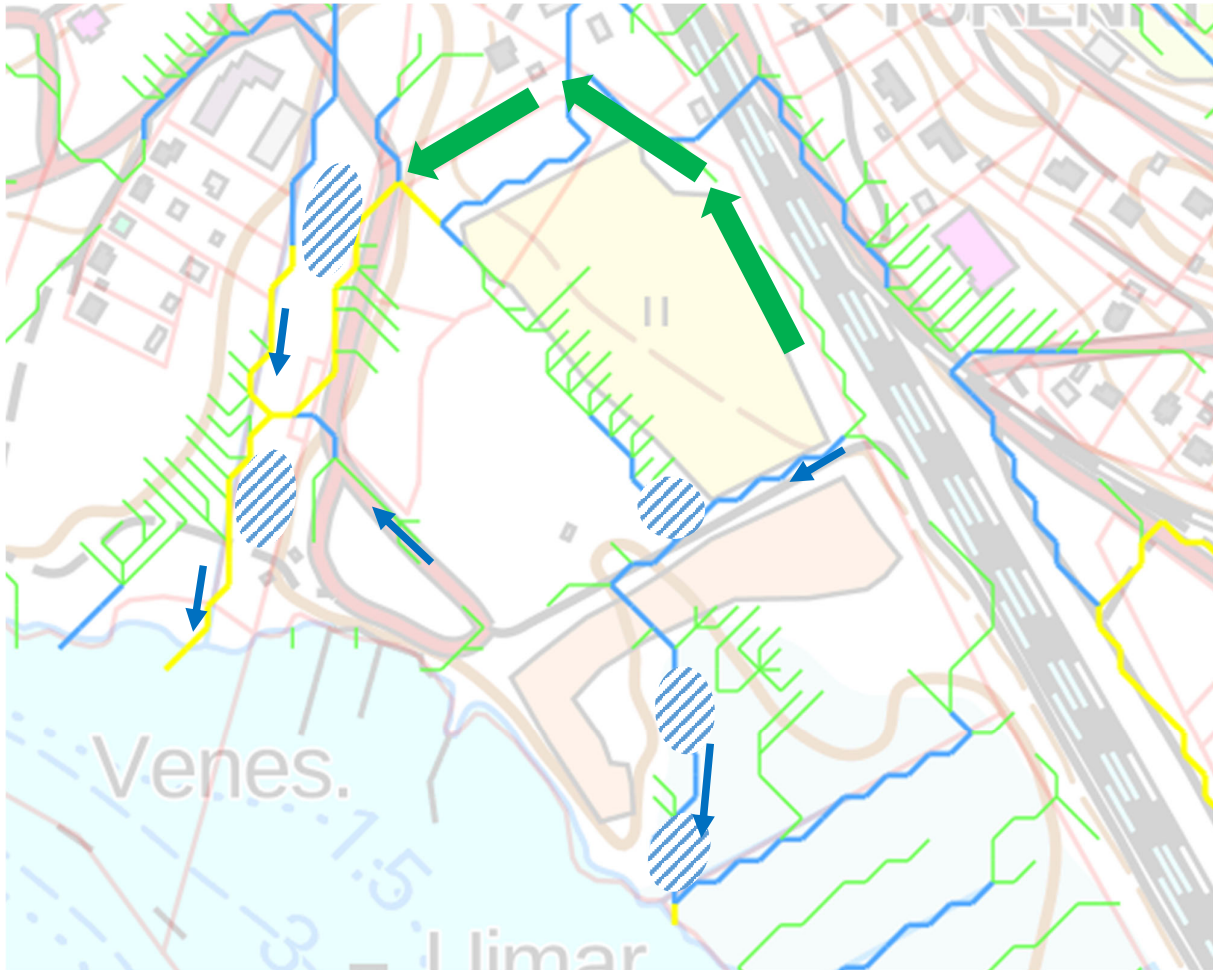
Kuva 21. Alustava yleispiirteinen suunnitelma alueen hulevesien hallinnasta.
