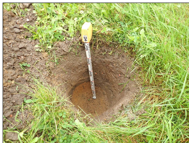
Koekuoppa 1 linjan itäpäässä. Koekuopassa oli pellon muokkauskerroksen alla hiekkaa, joka oli värjäätynyttä ja irtonaista, minkä vuoksi se vaikutti paikalle tuodulta. Vasen kuva länteen.
