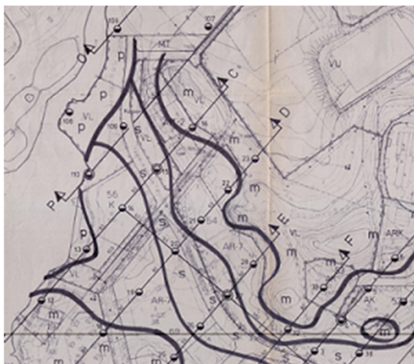
Pohjatutkimusselvityksessä täydennettiin kaavoitusvaihtoehtojen geoteknistä vertailua. Tässäkin selvityksessä suunnittelualueen maalajien todettiin olevan savea sekä myös silttiä. Suunnittelualueen rannassa on kapea alue, jossa on pehmeikköalue. Selvityksessä savi- ja silttikerroksissa huomattiin huomattavia tiiviyseroja.
