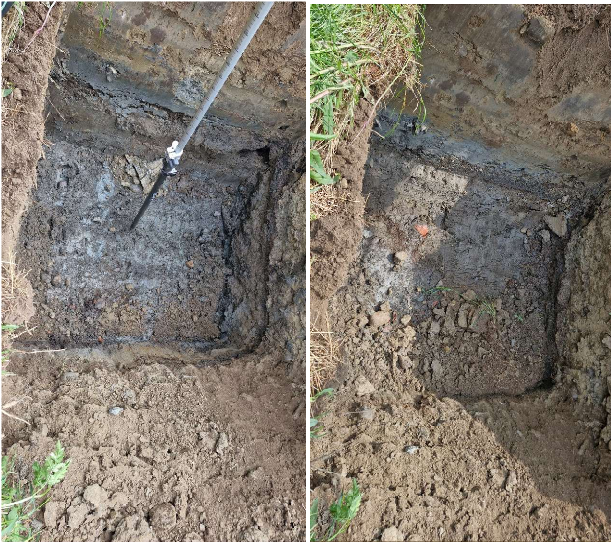
Kuvat 23 ja 24. Koekuoppa 17 kaivuuta. Maanpinta +81,07 m, pohja +79,597 m. Maaperä multa, hiekka/hieta, sora, siltti/savi. Havaittiin yksittäisiä tiilen palasia tasolla +79,95 m.
