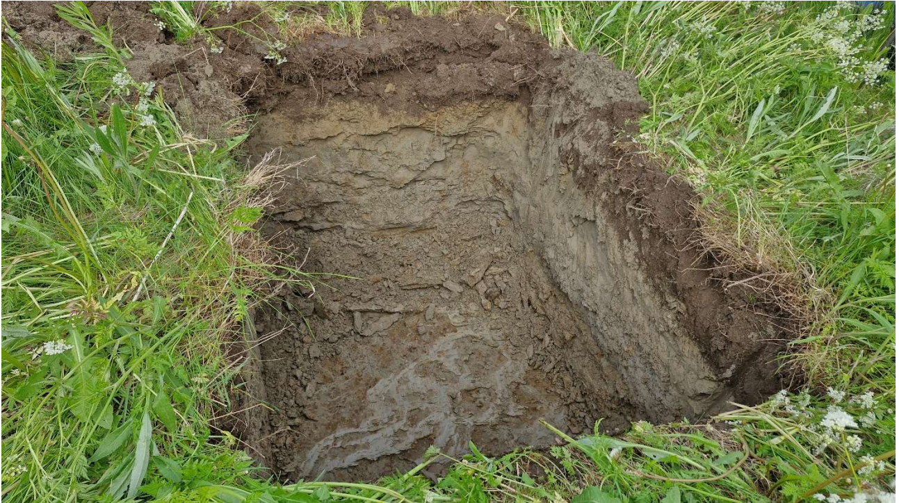
Kuva 17. Koekuoppa 9 kaivuuta. Maanpinta +81,89 m, pohja +80,707 m. Maaperä multa, hiekka/hieta, siltti/savi. Ei havaittu jätettä.
