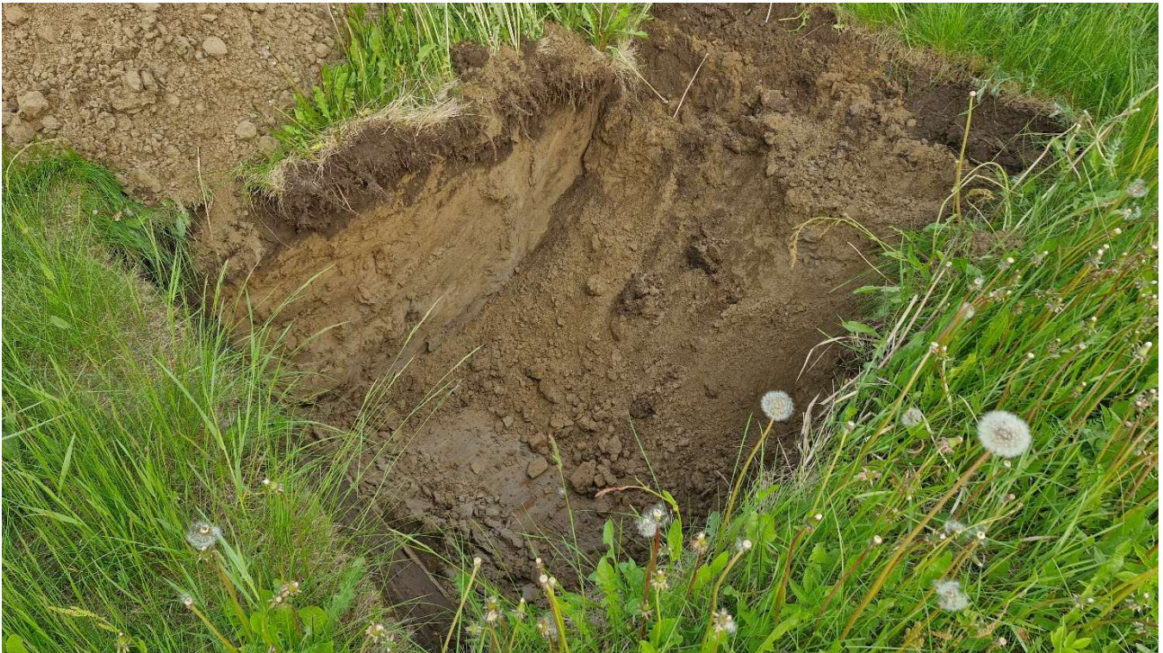
Kuva 9. Koekuoppa 1 kaivuuta. Maanpinta +83,89 m, pohja +82,703 m. Maaperä multa, hiekka/hieta, siltti. Ei havaittu jätettä.
