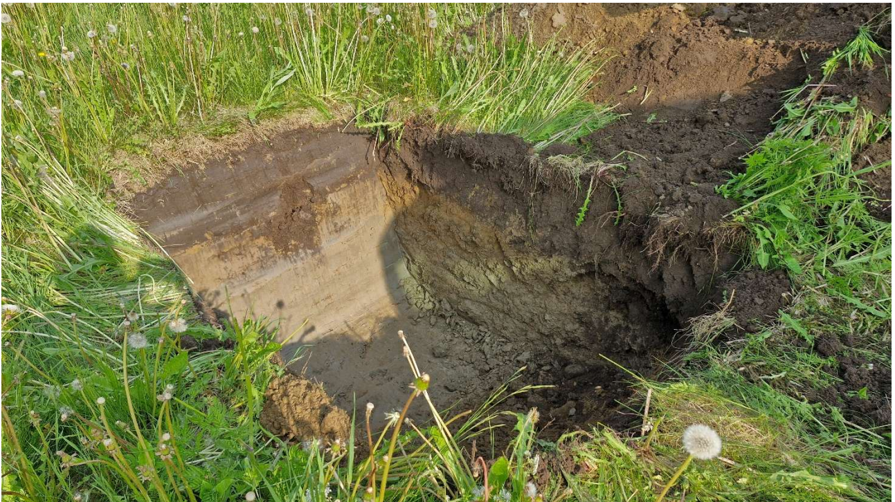
Kuva 12. Koekuoppa 4 kaivuuta. Maanpinta +82,70 m, pohja +81,583 m. Maaperä multa, hiekka/hieta, siltti. Ei havaittu jätettä.
