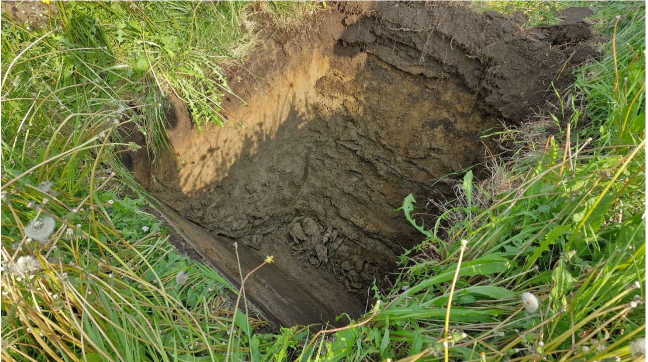
Kuva 11. Koekuoppa 3 kaivuuta. Maanpinta +83,01 m, pohja +81,153 m. Maaperä multa, hiekka/hieta, siltti/savi. Ei havaittu jätettä.
