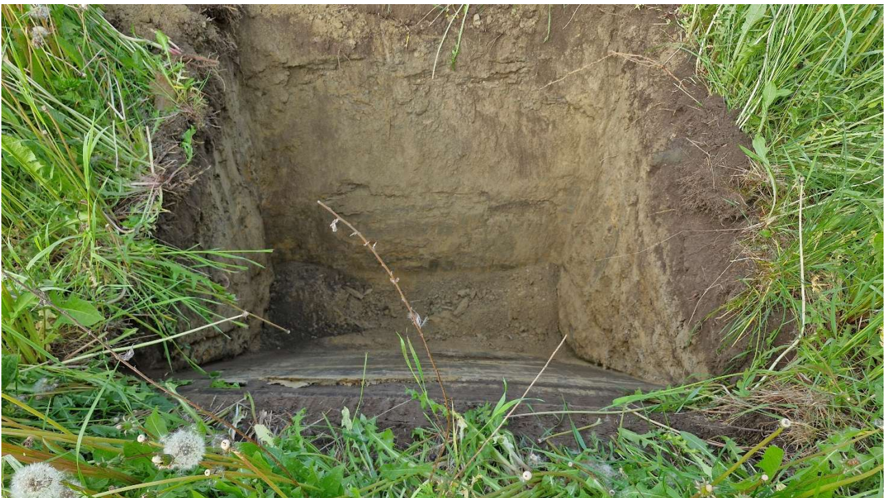
Kuva 10. Koekuoppa 2 kaivuuta. Maanpinta +83,77 m, pohja +82,327 m. Maaperä multa, hiekka/hieta. Ei havaittu jätettä.
