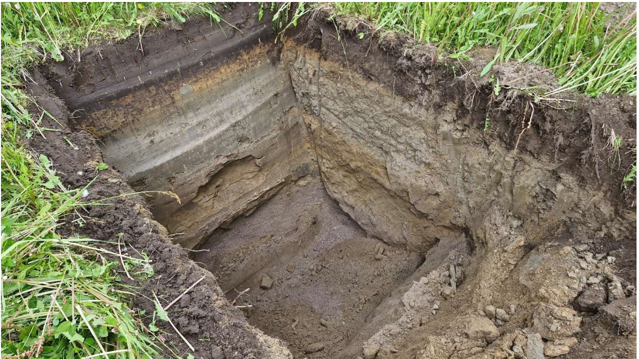
Kuva 22. Koekuoppa 18 kaivuuta. Maanpinta +83,04 m, pohja +80,845 m. Maaperä multa, hiekka/hieta. Ei havaittu jätettä.
