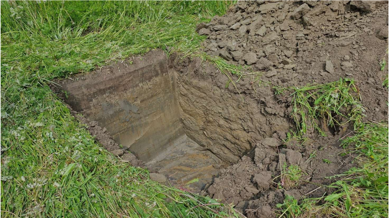
Kuva 19. Koekuoppa 11 kaivuuta. Maanpinta +82,26 m, pohja +80,652 m. Maaperä multa, hiekka/hieta, siltti. Ei havaittu jätettä.
