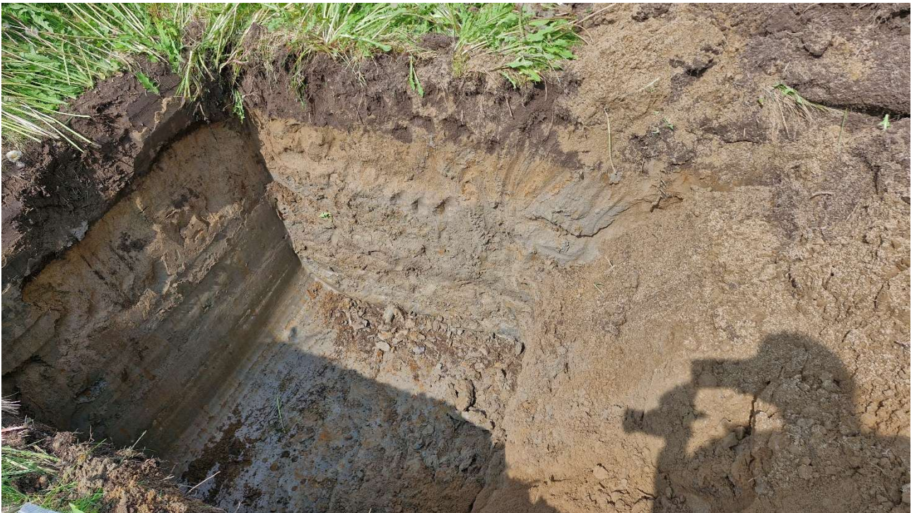
Kuva 20. Koekuoppa 12 kaivuuta. Maanpinta +81,39 m, pohja +79,851 m. Maaperä multa, hiekka/hieta, siltti/savi. Ei havaittu jätettä.
