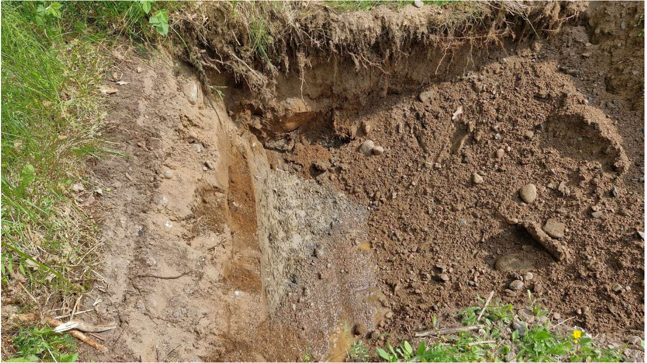
Kuva 27. Koekuoppa 14 kaivuuta. Maanpinta +81,19 m, pohja +80,220 m. Maaperä humusmaa, hiekkamoreeni, hiekka/hieta, siltti. Vettä tihkuu pohjan tasolla.
