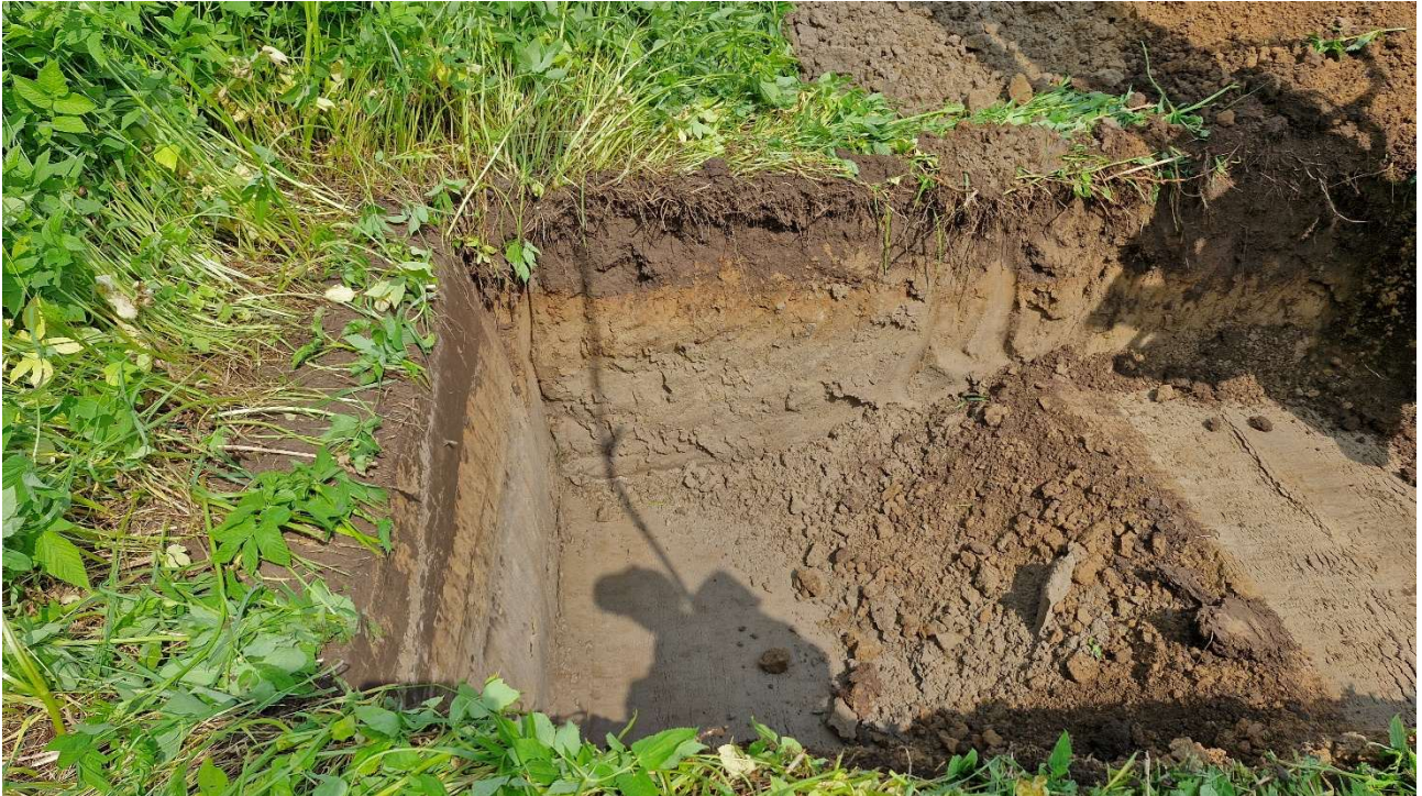
Kuva 21. Koekuoppa 13 kaivuuta. Maanpinta +81,09 m, pohja +79,977 m. Maaperä multa, hiekka/hieta, siltti. Ei havaittu jätettä. Vettä tihkuu hieman maakerroksista syvyydellä +80,00 m.
