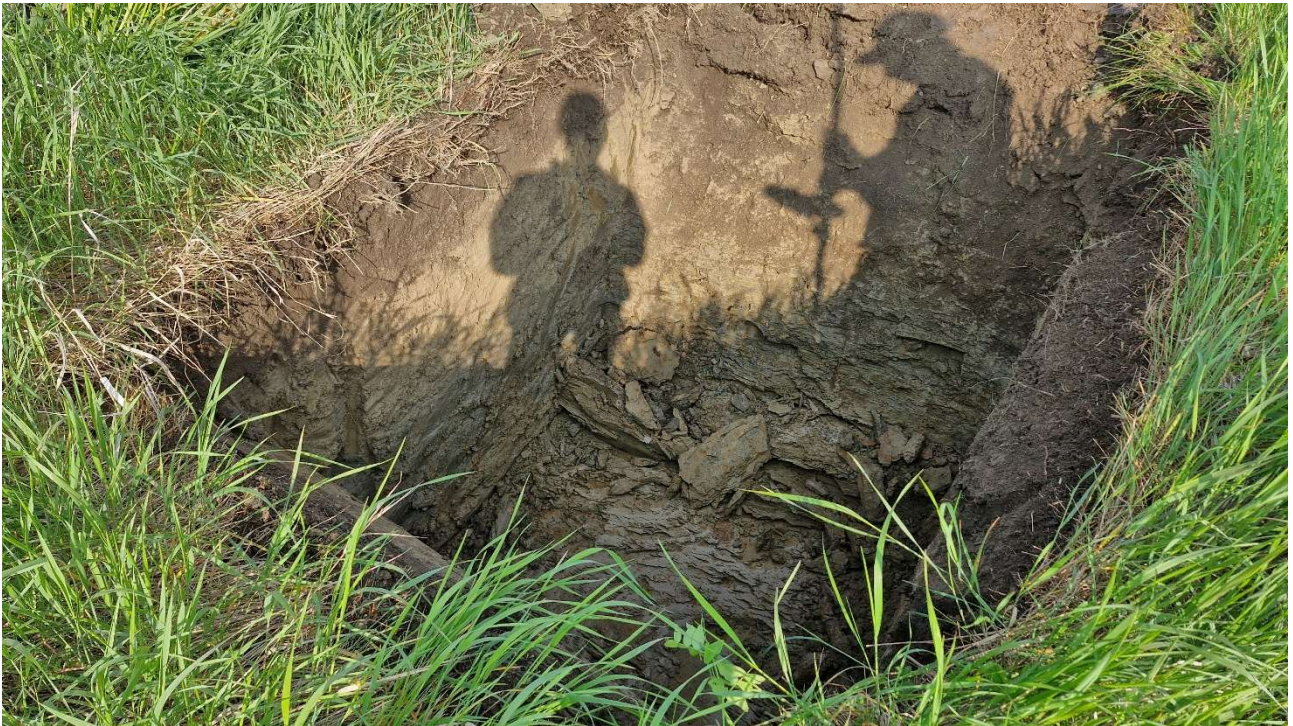
Kuva 13. Koekuoppa 5 kaivuuta. Maanpinta +82,89 m, pohja +81,255 m. Maaperä multa, hiekka/hieta, siltti/savi. Ei havaittu jätettä.
