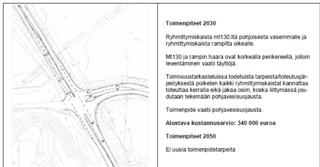
Kuva 17. Toimenpidetarpeet mt 130 ja 292 liittymän rampissa, mt 130.
