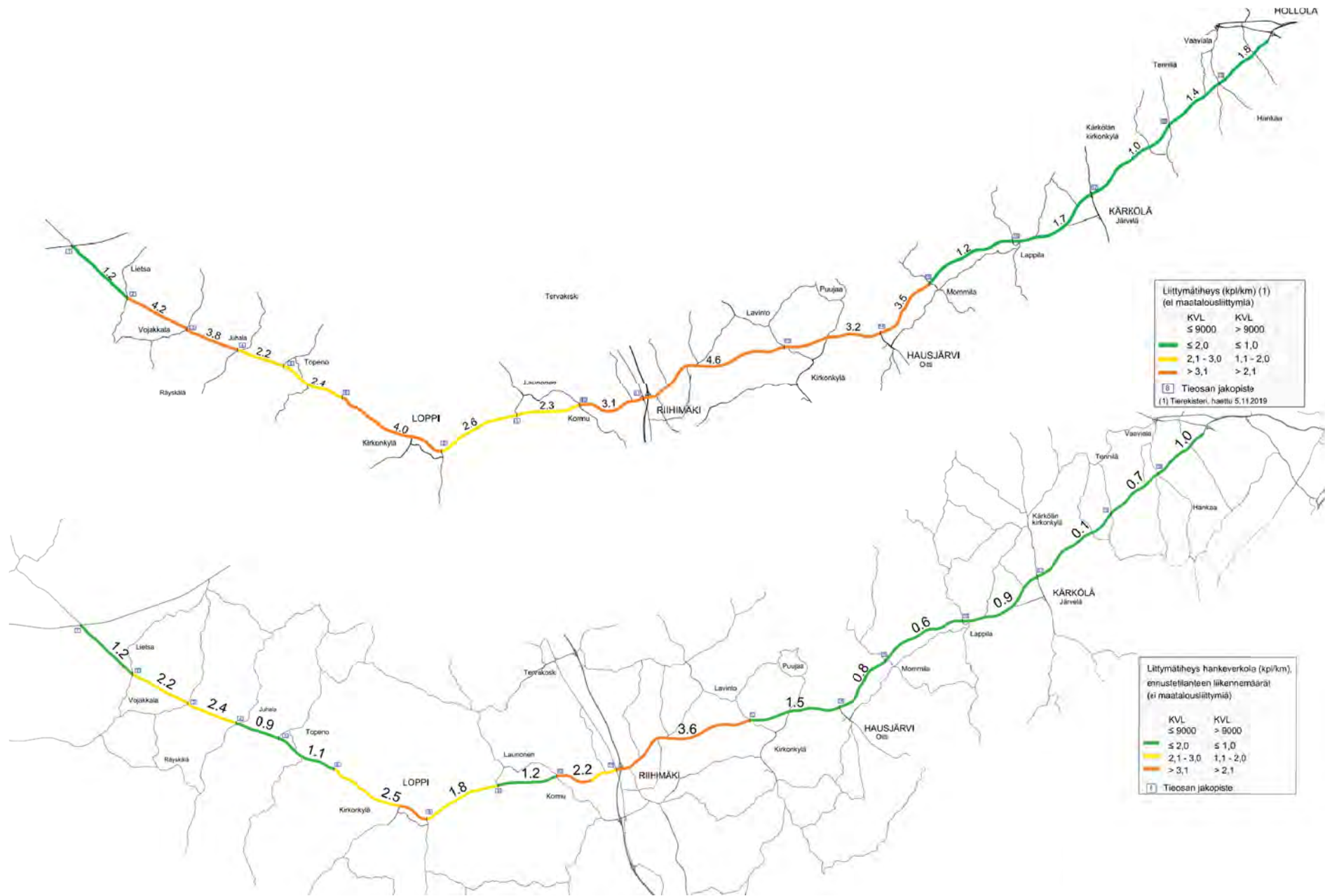
Kuva 5.1. Kantatien liittymätiheys tielosittain nykytilanteessa (ylhäällä) ja toimenpiteiden jälkeen (alhaalla).
