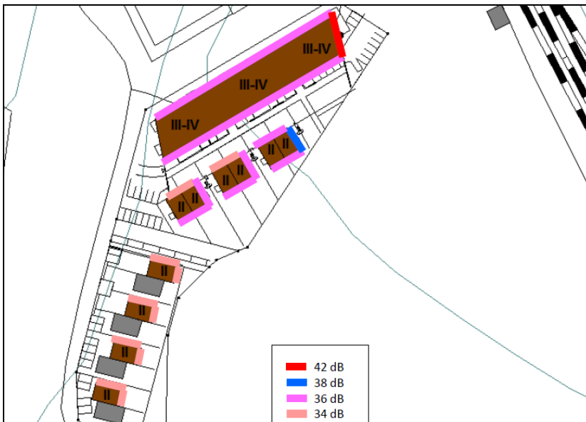
Kuva 14. Julkisivuun kohdistuvan hetkellisen maksimiäänitason perusteella lasketut julkisivujen ääneneristävyysvaatimukset sisä-äänitason ohjearvojen täyttymiseksi. Takaa myös keskiäänitasojen täyttymisen.
