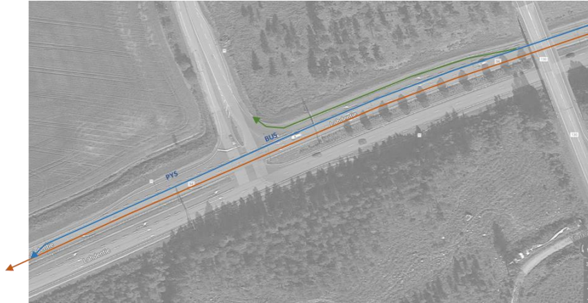
Kuva 15. Kt 54: kaistajärjestelyperiaate mt 130 rampin kohdalla harkittavaksi. Edellyttää muutoksia myös itäpäähän 2-kaistaisen osuuden alkuun (Kirjauksentien risteys).
